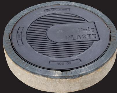
Produktová řada k odvodnění komunikací, z materiálu ROVASCO zahrnuje plastové kanalizační poklopy a vtokové mříže. Používají se jako náhrady litinových mříží a poklopů. Jsou to plastové monolyty bez kovových či jiných výztuh, koncipovány do standardně používaných litinových nebo betono-litinových rámů. Dodávají se samostatně nebo s BEGU rámem.
